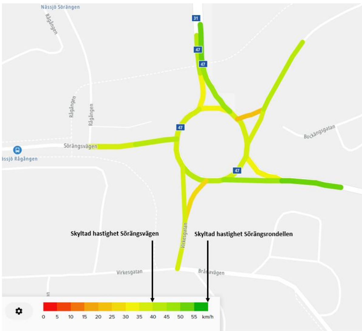
Figur 7. Medelhastigheter under maxtimmen.
